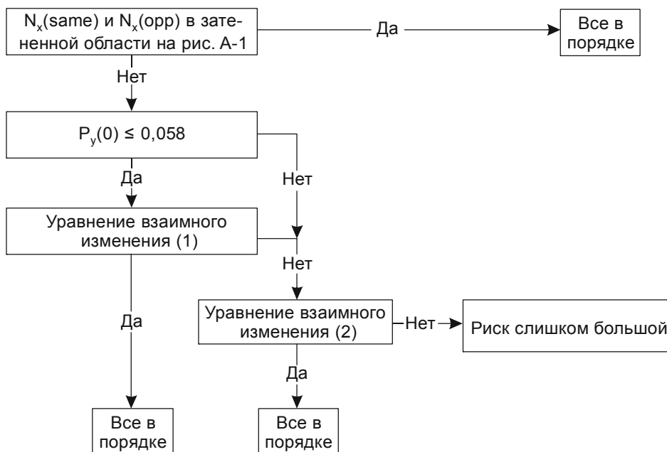
Рис. А-2. Блок-схема взаимного изменения параметров глобальных технических требований к характеристикам системы применительно к воздушному движению в одном и встречных направлениях при P_y(0) \leq 0,058 и при условии, что P_z(1000) \leq 1,7 \times 10^{-8}
