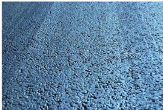
Рисунок А6-10. Текстура поверхности ВВА 0/14
