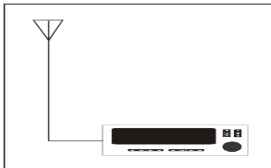
Рис.2 Система с отдельно установленной СНС(рис.3)
