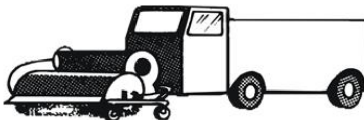
Широкопососный мощный очиститель (более 3,8 м) толкаемого типа с двумя двигателями, переднерасположенное устройство для одуваания: обычная кабина
