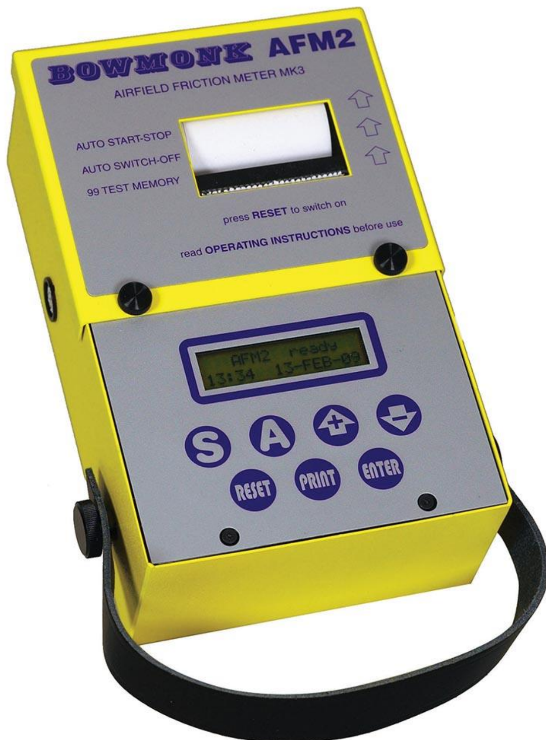
Рис.5-16. Электронный таплиметр для измерения сцепления на летном поле
