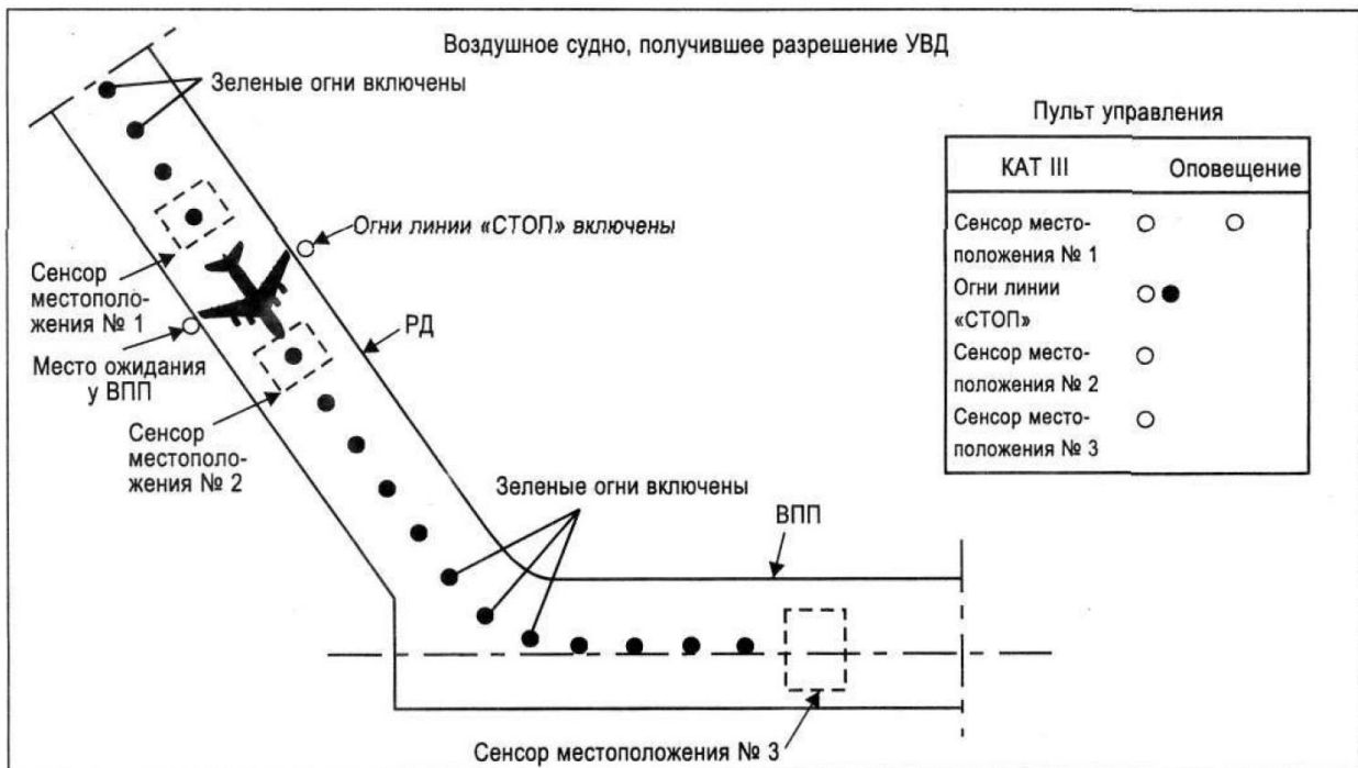
Рисунок 10-3. Управление огнями линии «СТОП» посредством сенсоров местоположения. Воздушное судно пересекает огни линии «СТОП»
