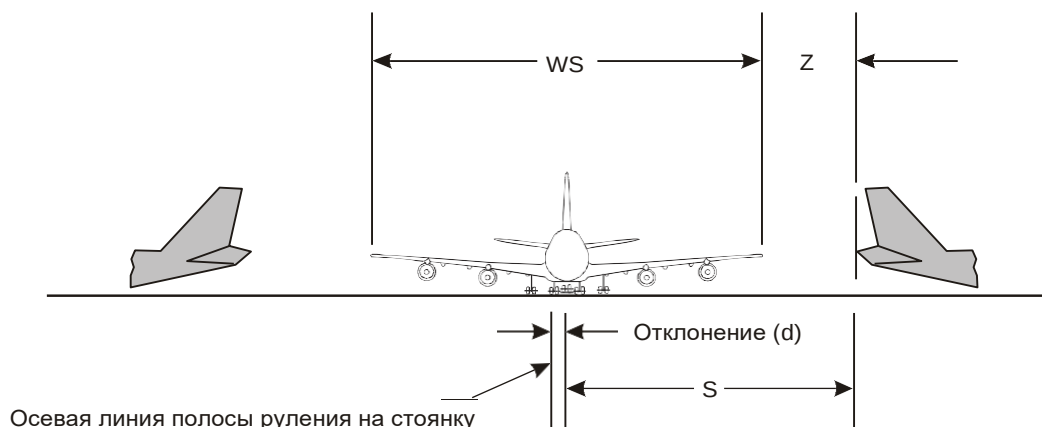
Рис. 1-22. Геометрическое построение расстояния от полосы руления воздушного судна на стоянку до объекта
