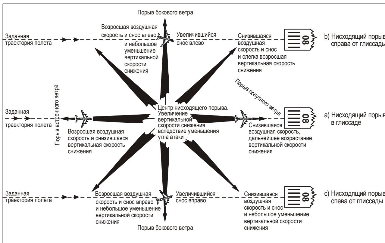
**Рис. 4-10. Воздействие на воздушное судно, производящее посадку через зону нисходящего порыва, в трех местах расположения последнего относительно глиссады при предполагаемом невмешательстве пилота (вид сверху)**
