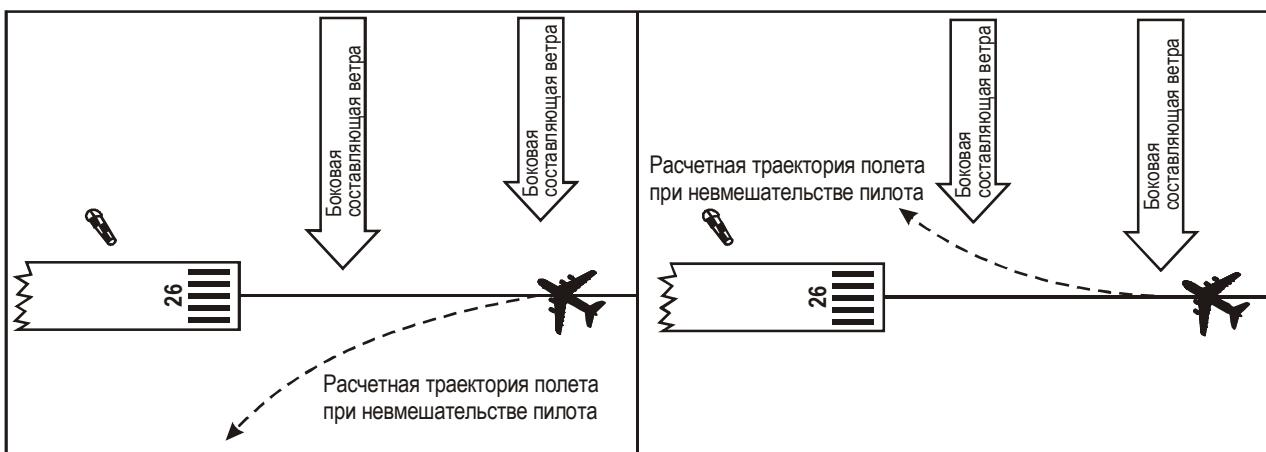
**Рис. 4-9. Воздействие сдвига бокового ветра на воздушное судно при предполагаемом невмешательстве пилота**
