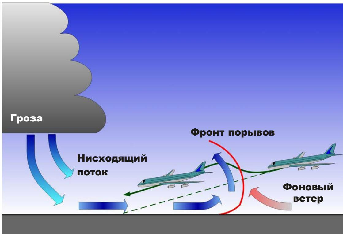
Рис. А4-4. Сдвиг ветра, вызванный фронтом порывов
