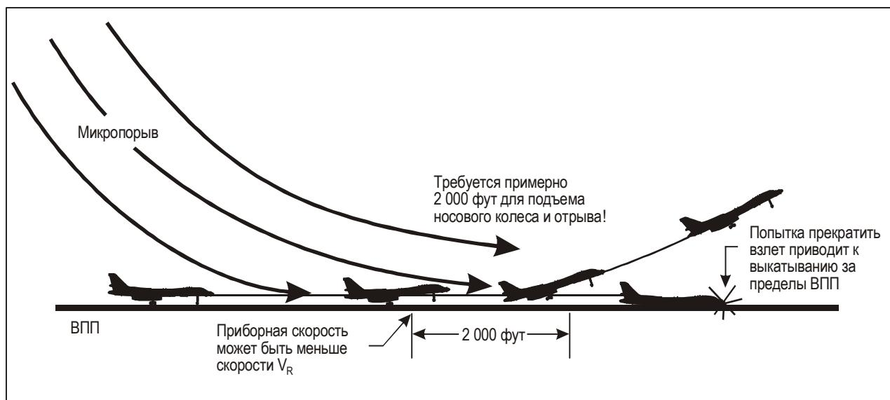
**Рис. 4-15. Влияние сдвига ветра на решение о подъеме носового колеса. Воздействие сдвига ветра может заставить начать подъем носового колеса на скоростях ниже  $V_r$ .**
