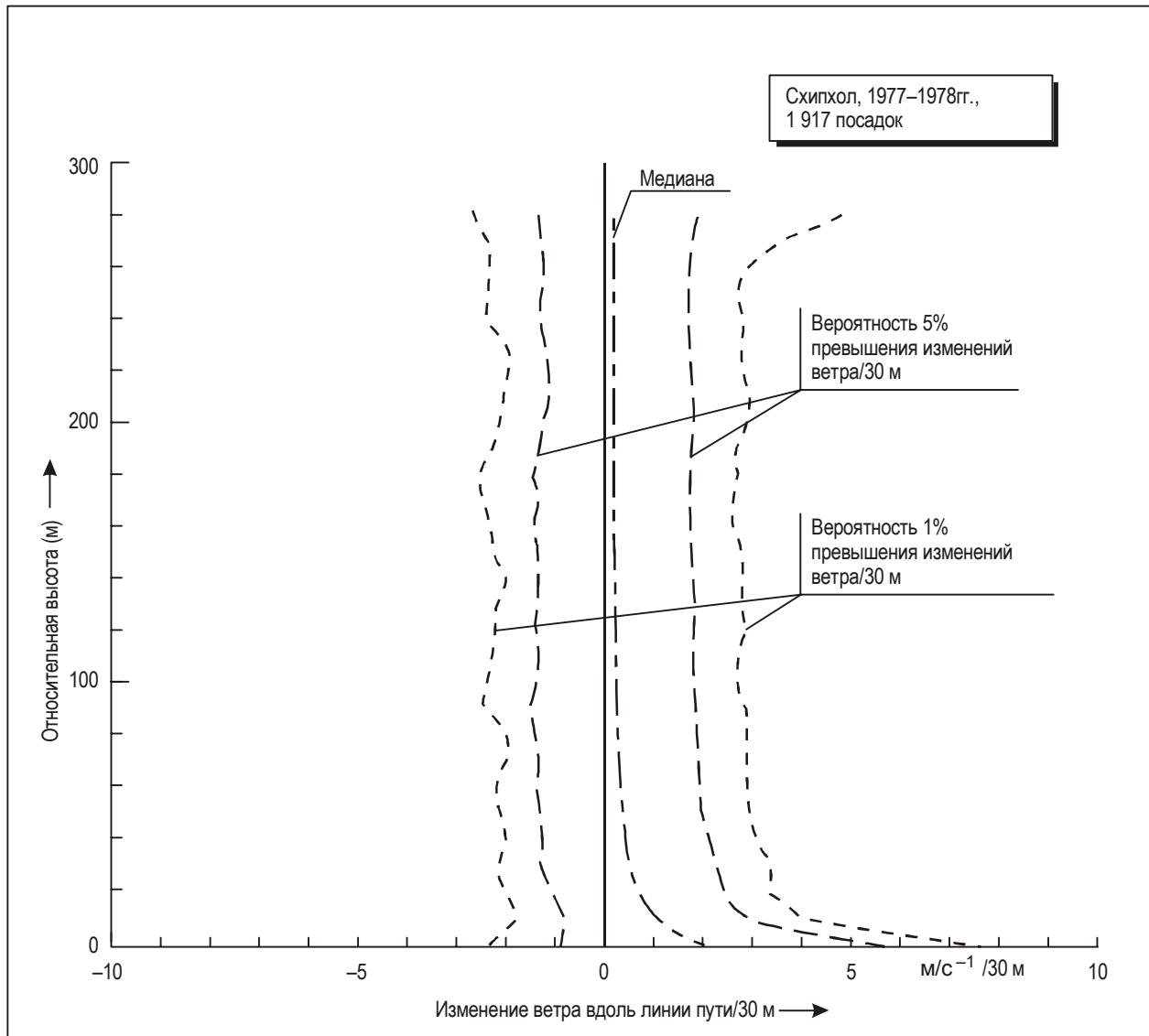
**Рис. 3-26. Вероятность 50, 5 и 1 % превышения изменения ветра вдоль линии пути/30 м на одну посадку, с изменением высоты**
