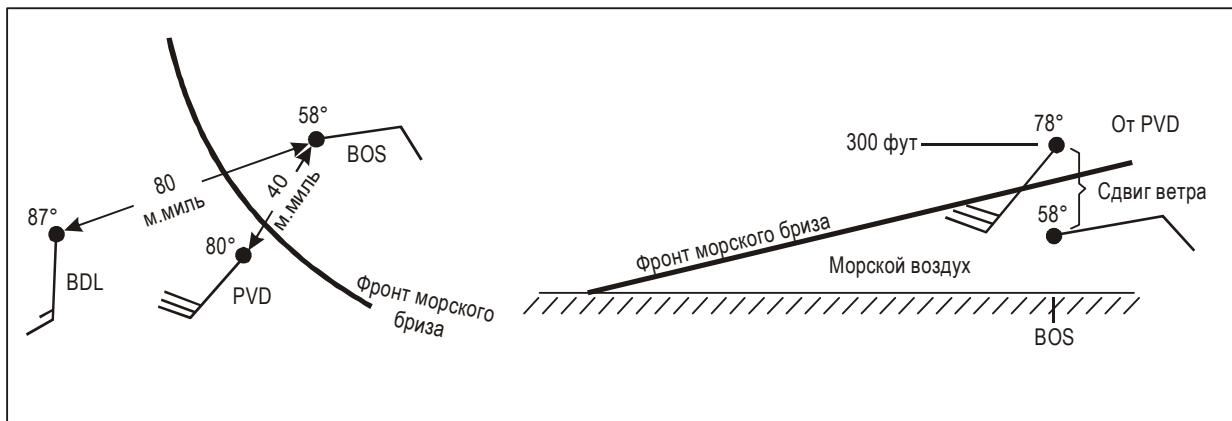
**Рис. 5-11. Сдвиг ветра, связанный с морским бризом**
