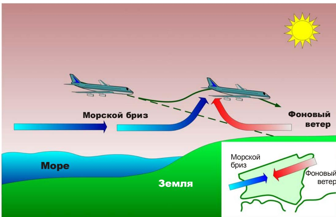
Рис. А4-5. Сдвиг ветра, вызванный морским бризом
