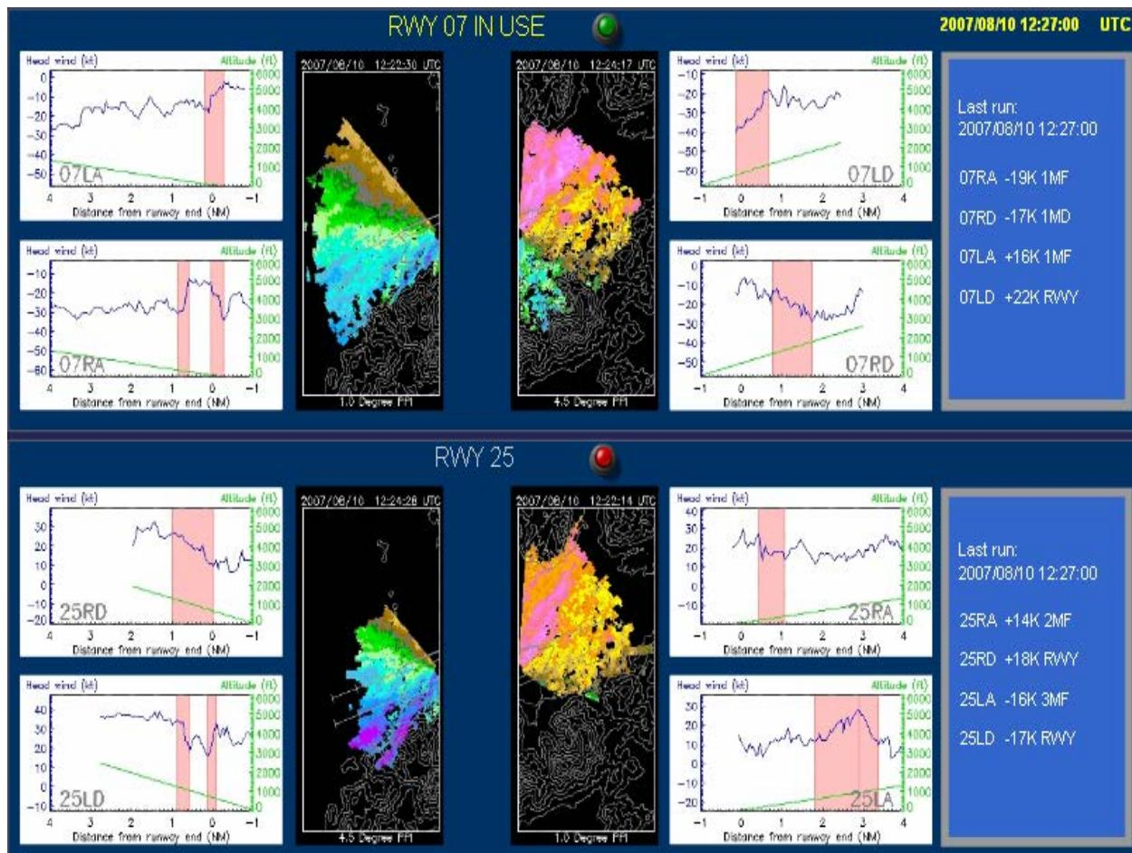
**Рис. 5-7. На индикаторе LIWAS показаны профили встречного ветра вдоль различных коридоров ВПП аэропорта НКИА (голубые кривые) и обнаруженный сдвиг ветра (выделено красным цветом) (представлено НКО)**
