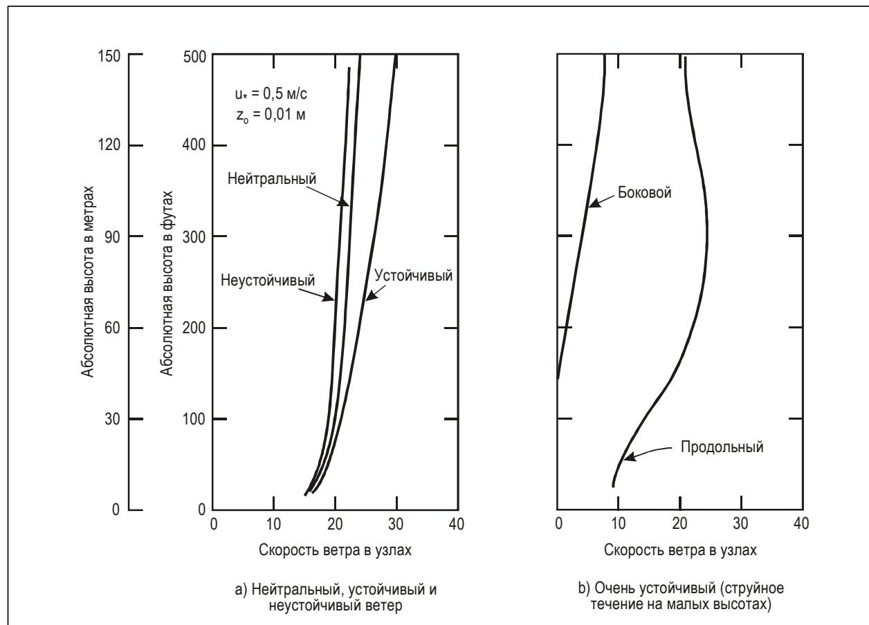
Рис. 3-1. Профили ветра при атмосферном воздействии пограничного слоя
