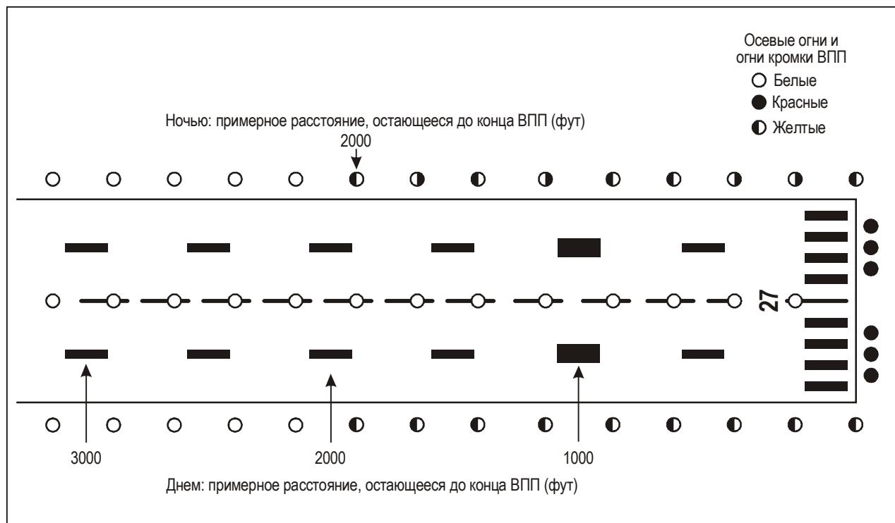
**Рис. 4-18. Маркировка и огни ВПП, не оборудованной
