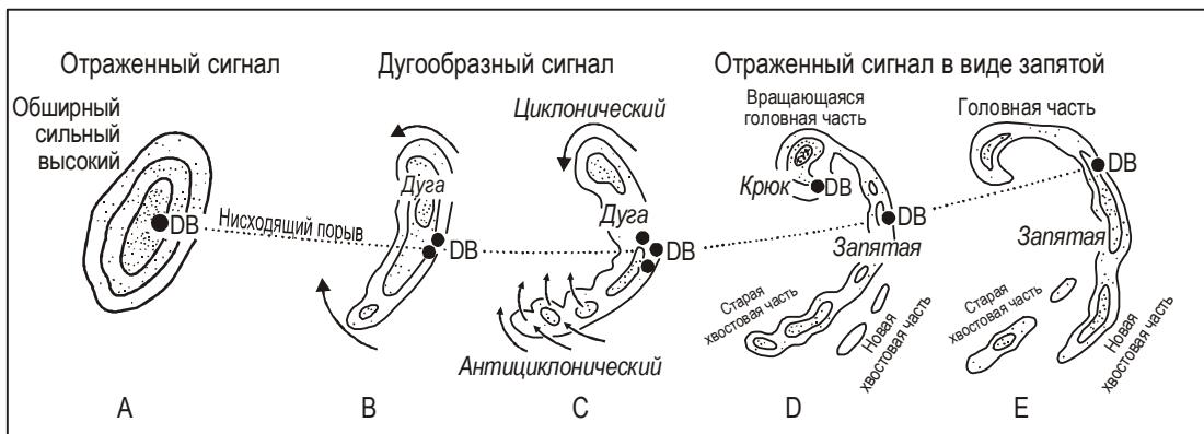
b) Типичная морфология отраженных радиолокационных сигналов, связанных с сильными и обширными нисходящими порывами. Некоторые дугообразные сигналы распадаются до превращения в сигналы в виде запяты. В течение периода самых сильных нисходящих порывов отраженный сигнал часто принимает кольевидную форму или форму выступа с острием в сторону движения (точка "DB" обозначает местоположение нисходящего порыва).
