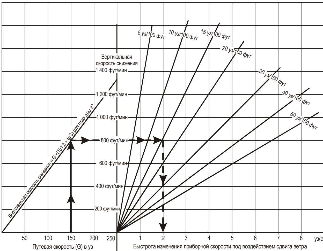
**Рис. 4-5. Быстрота изменения приборной воздушной скорости под воздействием сдвига ветра и вертикальная скорость снижения воздушного судна**
