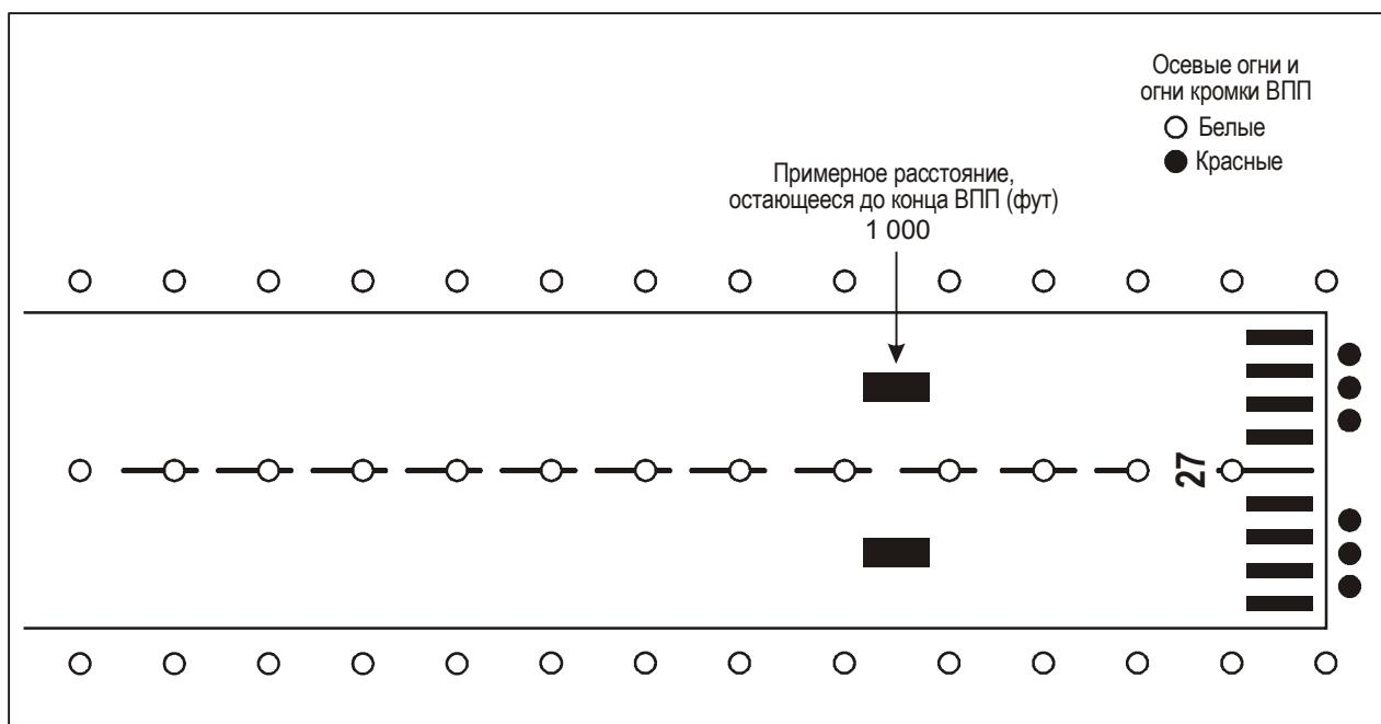
**Рис. 4-17. Маркировка и огни ВПП, не оборудованной для точного захода на посадку согласно стандартам ФАУ**
