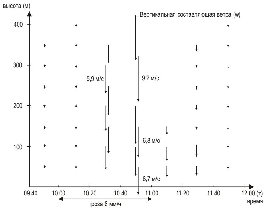
б) профиль вертикальной составляющей ветра 9 июня 1984 г.
