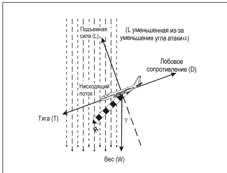
**Рис. 4-4. Результатирующий вектор траектории полета, связанный со сдвигом в вертикальной составляющей ветра (нисходящем потоке) — гипотетическом остронаправленном устойчивом нисходящем потоке**
