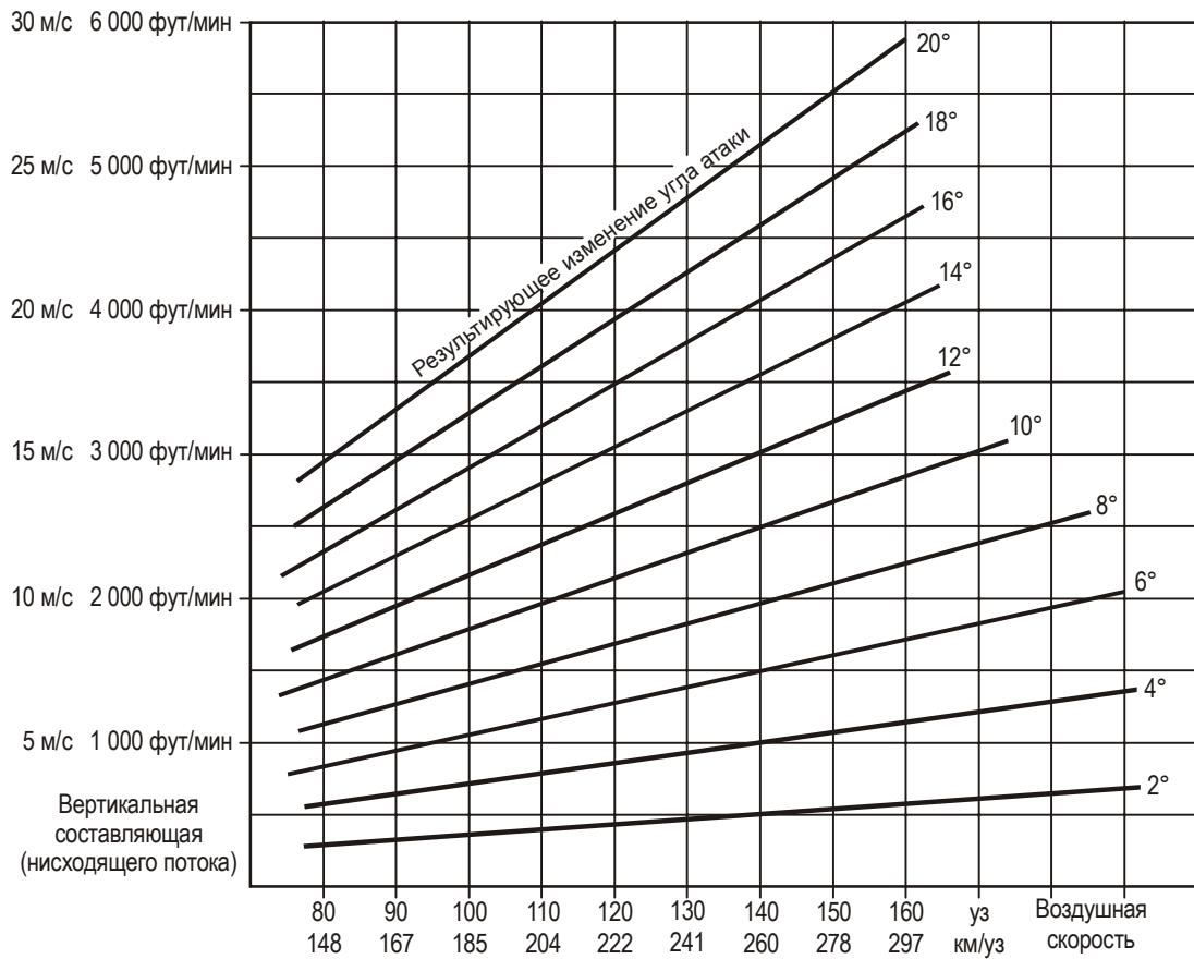
c) Уменьшение угла атаки в результате различных комбинаций воздушной скорости и вертикальной составляющей ветра (нисходящего потока)
