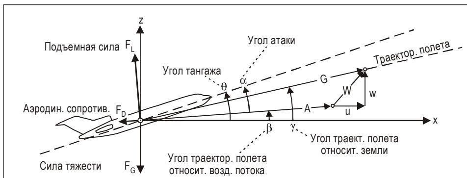
**Рис. А3-1. Обозначение параметров, использованных в настоящей главе  $F_L$  – подъемная сила;  $F_G$  – сила тяжести;  $F_D$  – аэродинамическое сопротивление;  $\alpha$  – угол атаки;  $\beta$  – угол траектории полета относительно воздушного потока;  $\gamma$  – угол траектории полета относительно земли;  $\theta$  – угол тангенса;  $W$  – вектор ветра,  $u$ ,  $v$ ,  $w$  составляющие вектора ветра по  $x$ ,  $y$ ,  $z$ ;  $A$  – истинная воздушная скорость и  $G$  – путевая скорость**
