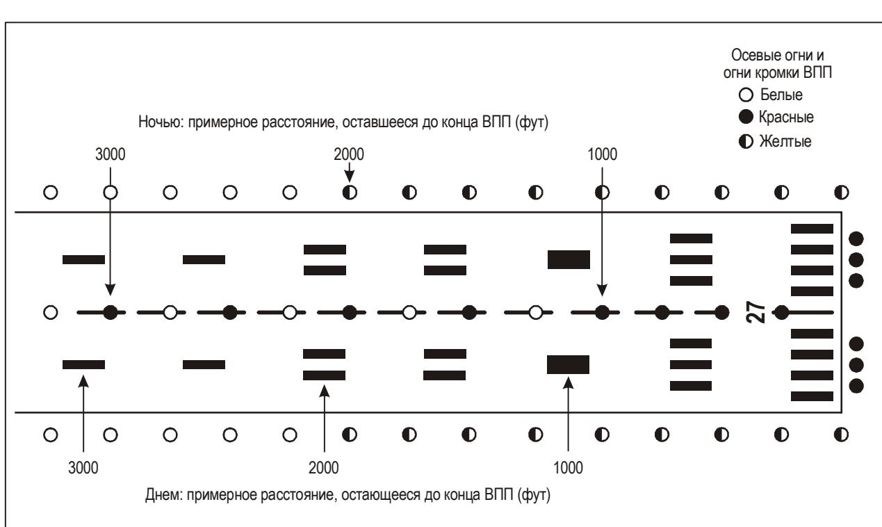
**Рис. 4-16. Маркировка и огни ВПП, оборудованной для точного захода на посадку согласно стандартам ИКАО/ФАУ**
