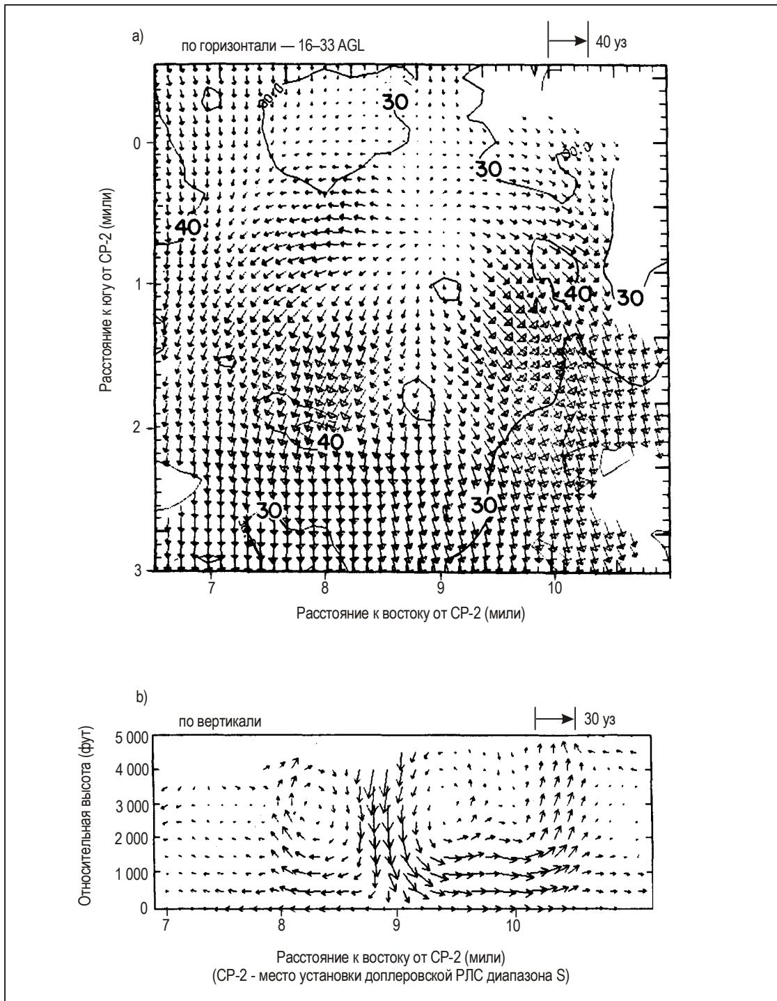
**Рис. 3-15. Поля скоростей относительно земли по результатам анализа микропорыва, имевшего место 14 июля 1982 г. в 1452 MDT. Кривые представляют коэффициенты отражения РЛС ( $\text{dBZ}_e$ )**
