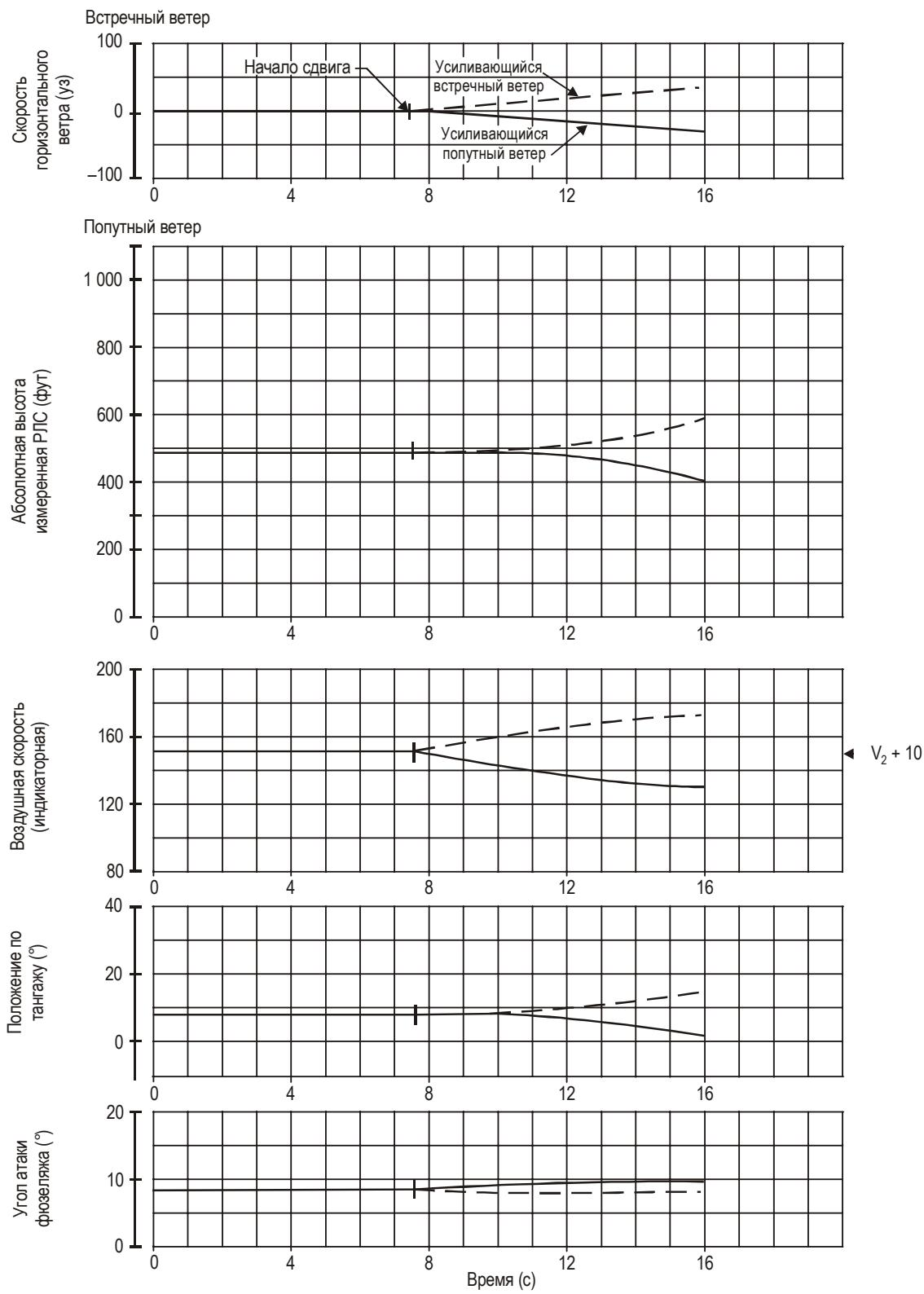
**Рис. 4-6. Начальная реакция воздушного судна с фиксированным положением органов управления на сдвиг составляющих встречного/попутного ветра**
