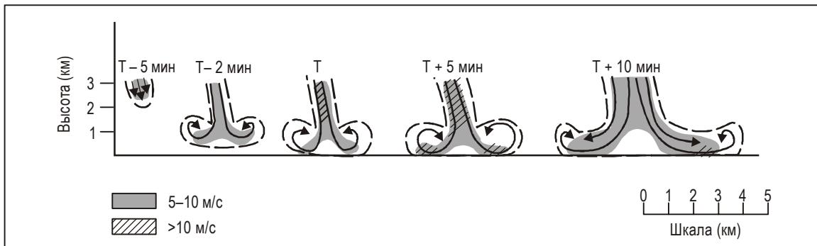
**Рис. 3-17. Вертикальный разрез поля ветра, относящегося к микропорыву;**
