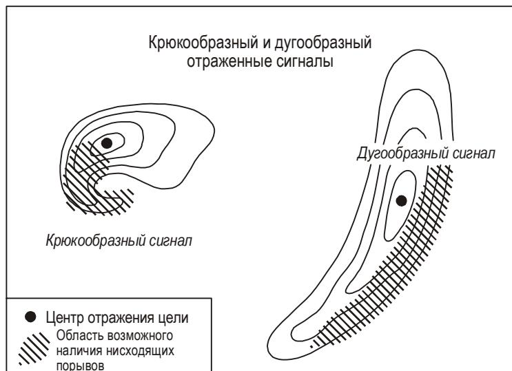
a) Крюкообразные и дугообразные отраженные сигналы обычно наблюдаются при нисходящих порывах. Линейная волновая схема отраженных сигналов (LEWP) часто включает быстродвижущийся дугообразный отраженный сигнал. Максимальная отражательная способность дугообразного сигнала часто наблюдается слева от центра дуги.
