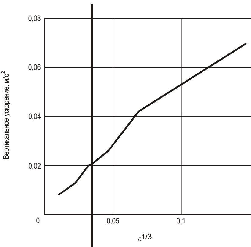
**Рис. 5-8. Изменение вертикального ускорения относительно кубического корня скорости затухания вихря**
