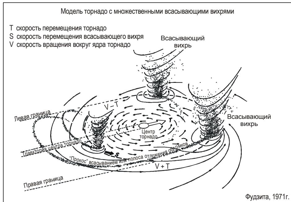
**Рис. 3-19. Модель торнадо с множественными всасывающими вихрями**
