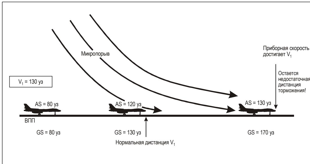
**Рис. 4-14. Влияние сдвига ветра на момент принятия решения о выполнении/не выполнении взлета. Скорость принятия решения  $V_1$  может быть не достигнута в точке, откуда оставшейся длины ВПП может не хватить для прекращения взлета**
