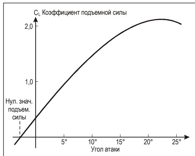
Рис. А3-2. Коэффициент подъемной силы воздушного судна со стреловидным крылом при отклоненных на  $15^\circ$  закрылках и убранном шасси. Угол атаки берется по отношению к фюзеляжу. Угол атаки по отношению к крылу приблизительно на  $2^\circ$  больше, чем угол атаки по отношению к фюзеляжу
