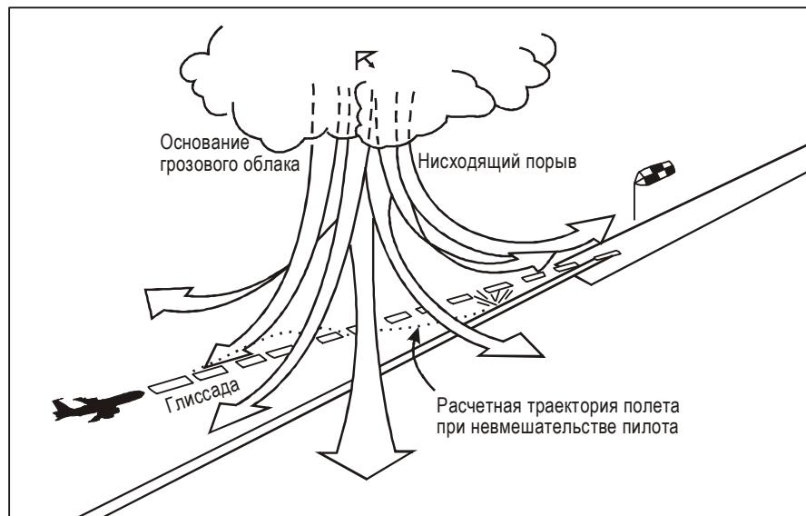
Рис. 4-11. При посадке с прохождением через нисходящий порыв
