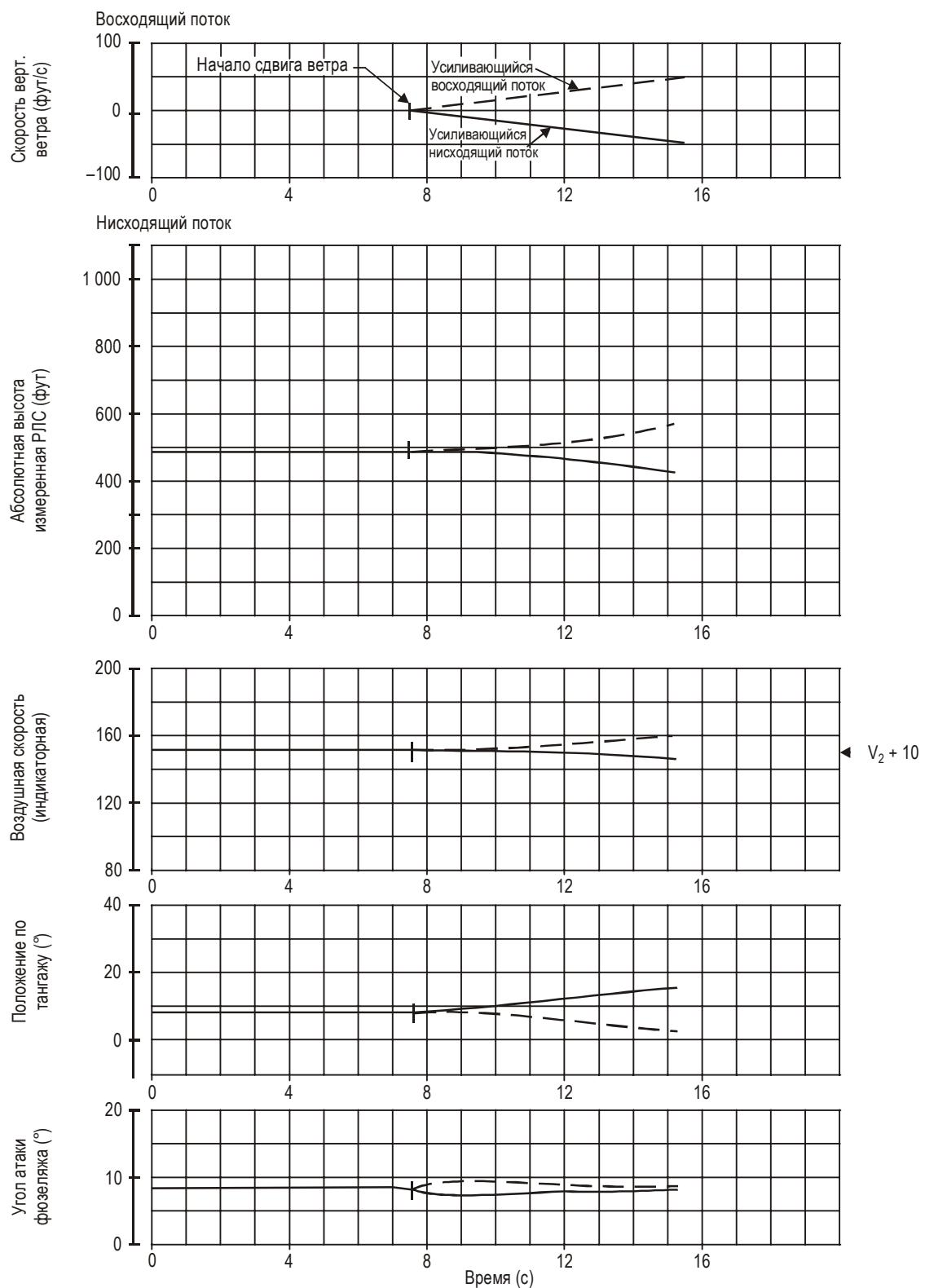
**Рис. 4-12. Начальная реакция ВС при фиксированном положении органов управления на воздействие вертикальных составляющих ветра (восходящий/нисходящий поток)**
