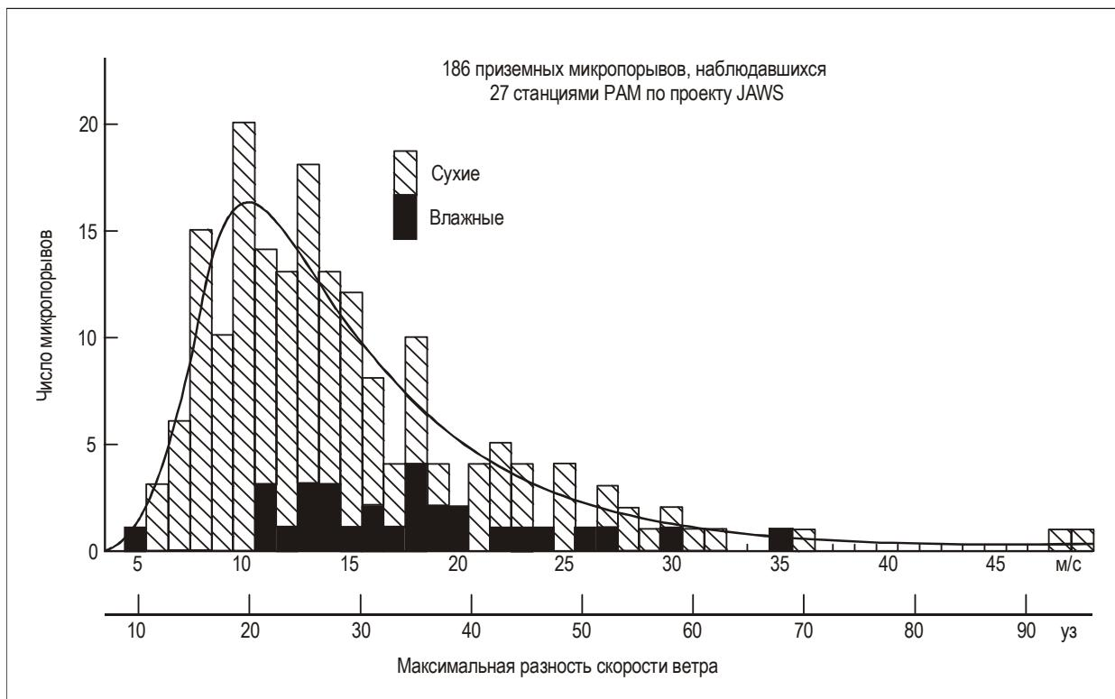
Рис. 3-14. Частота приземных микропорывов как функция максимальной разности скорости ветра, измеренной на 27 станциях РАМ
