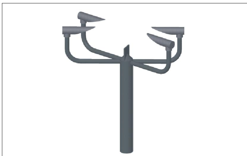
**Рисунок 8-3. Измеритель прямого рассеяния с четырьмя головками**
